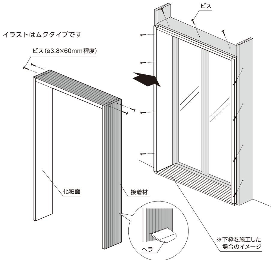
L字タイプを施工される場合は、縦枠の上端を下記を参考に9mmカットしてください。
