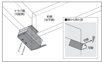
ケラバ水下の鼻隠し下地端部へ留付けます。
