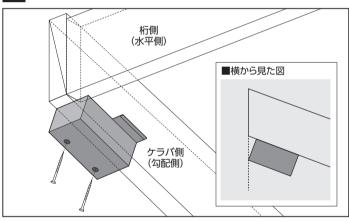
ケラバ側水上の鼻隠し下地の端部へ留付けます。
