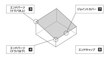
軒天換気材の端部納まりが発生する場合はエンドキャップを使用ください。 施工方法は各種ページを参照ください。また、セット内容は製品仕様欄を参照ください。
