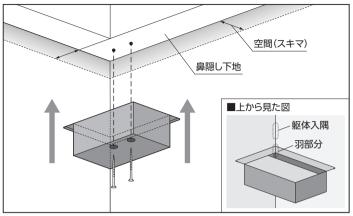
躯体入隅に換気材入隅部材 (FV-DE75SI) の羽部分を当て野縁に留め付けます。
