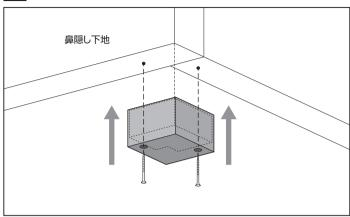
鼻隠し下地交点にせっこうボードの出隅部分を併せ、換気材出隅部材 (FV-DE75SD)を留め付けます。
