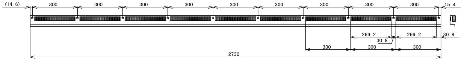
鋼板製 軒天換気材 詳細図 (S : 1/10)
