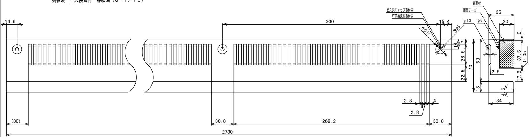
鋼板製 軒天換気材 詳細図 (S : 1/2)
