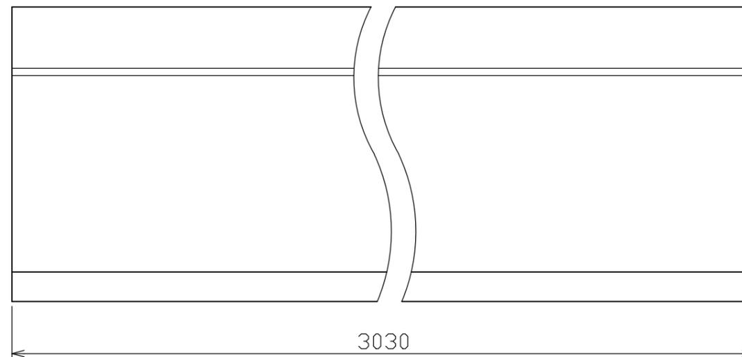
材料：ガルバリウム鋼板(厚さ：0.35mm)
