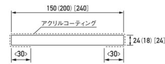
※アクリルコーティングの裏面の巻き込み寸法<30>は参考寸法です。    ※( )内寸法はW200サイズ    ※[ ]内寸法はW240サイズ
