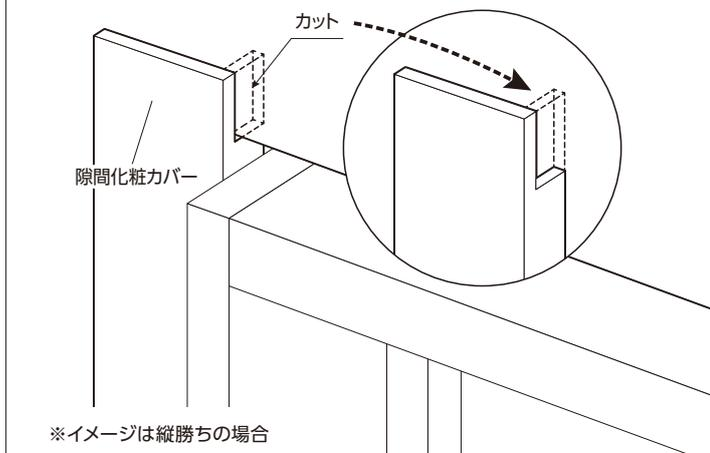
**3** 裏面のはくり紙をはがして下記参考納まり図の様に本製品をUBドア枠へ取り付けます。
