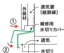
はめ込む際に外壁が当たる場合は、水切り上部分から差し込み、水切りカバーを取り付けます。
