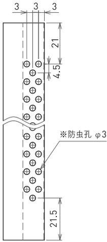
有効換気面積: ※防虫孔部分 23cm<sup>2</sup>/m
