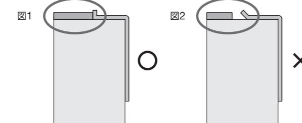
中間材の立ち上がりの倒れ防止のために面台下地を防水役物の立ち上がり部に当たるように施工してください。
