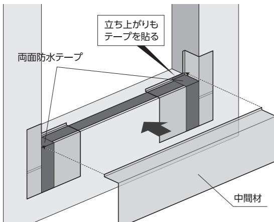
4 ③で窓用角に貼り付けた両面防水テープで窓用中間を固定します。
