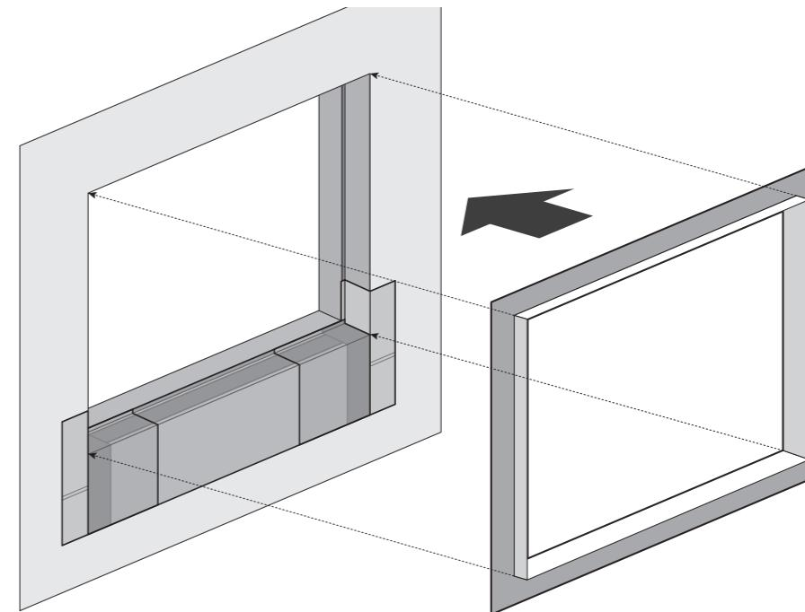
6 【施工①】サッシ枠左右のフィンに両面防水テープを貼ります。
