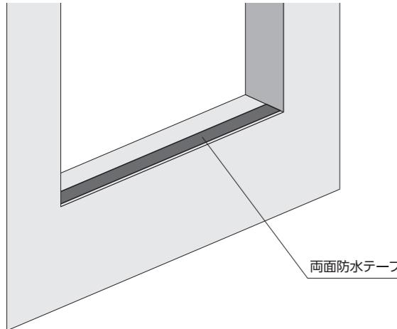
2 窓用角を開口部側面の角に沿わせて降ろし、開口部下端の角に合せて固定します。
