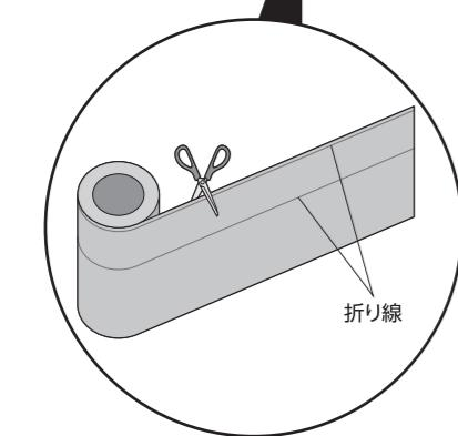
固定した窓用角の内面寸法に合わせて窓用中間をカットし、折り線に沿って90度になるように折り曲げてください。(右図参照)
