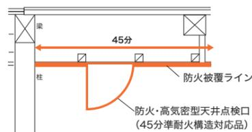
防火・高気密型天井点検口にすることで45分準耐火構造の防火被覆の連続性を確保できます。
