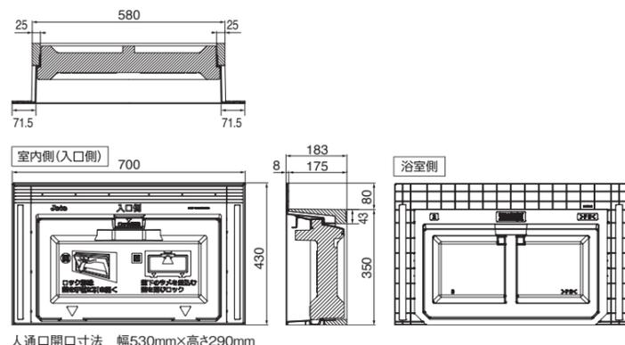
人通口開口寸法 幅530mm×高さ290mm
