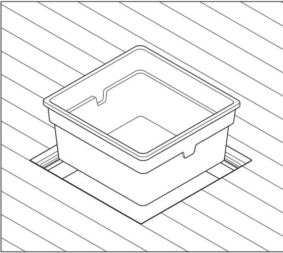
**2** 蓋を外枠へセットし、開閉に支障がないか、ガタツキがないかを確認してください。
