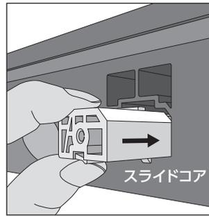
※外枠の内側から差し込む際は、図のバネ部分を押しながら差し込んでください。
