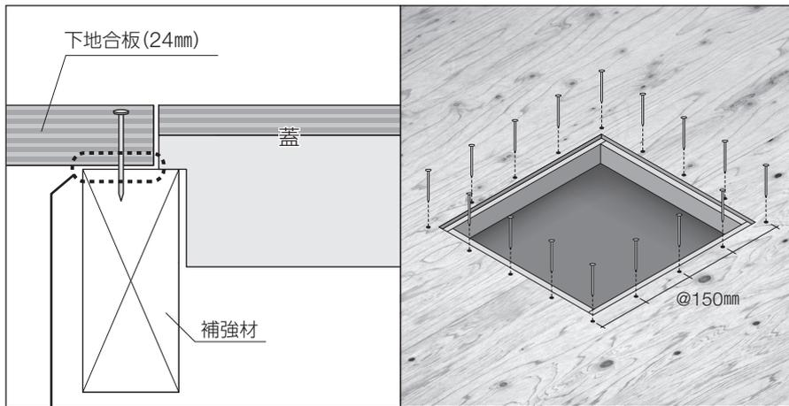
下地合板24mmと補強材の間に隙間が生じないように、釘又は木ネジにて留め付けをおこなってください。
