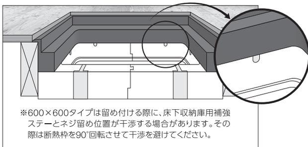
※600×600タイプは留め付ける際に、床下収納庫用補強ステーとネジ留め位置が干渉する場合があります。その際は断熱枠を90°回転させて干渉を避けてください。
