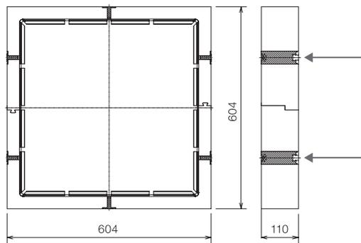
**1** 断熱枠をばらした状態で外枠から床下に入れ、断熱枠支持ブラケットのネジ穴がある方を上にして床下で組んでから、外枠の下端まで持ち上げます。
