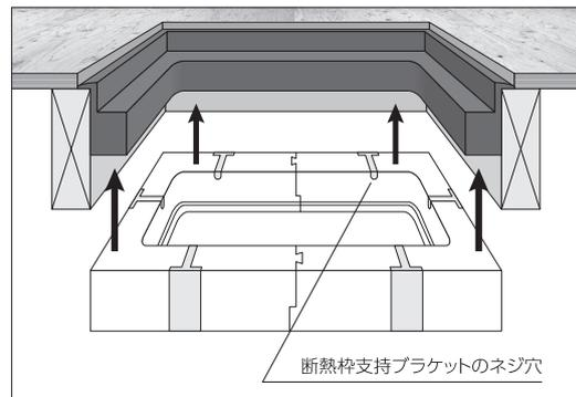
**2** 断熱枠支持ブラケットのネジ穴から、付属の取付ネジで補強材に留め付けます。
